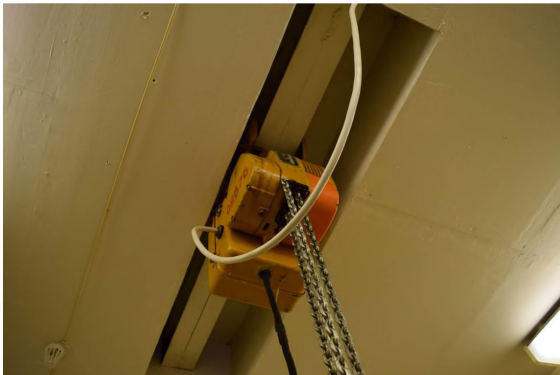
Фото 23. Электроталь грузоподъемностью 2 т.
